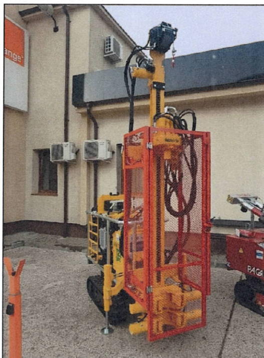
Figura 3.2 Utilaj de foraj Beretta T2
